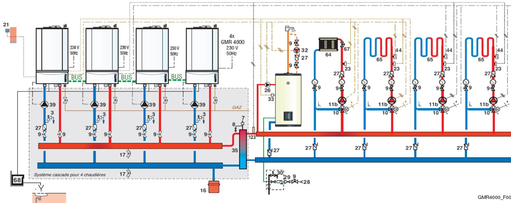
GMR 4045 Condens avec 1 circuit radiateurs + 1 circuit avec vanne mélangeuse + 1 système solaire OERTLISOL pour la préparation de l'ecs, tous trois derrière une bouteille de découplage
