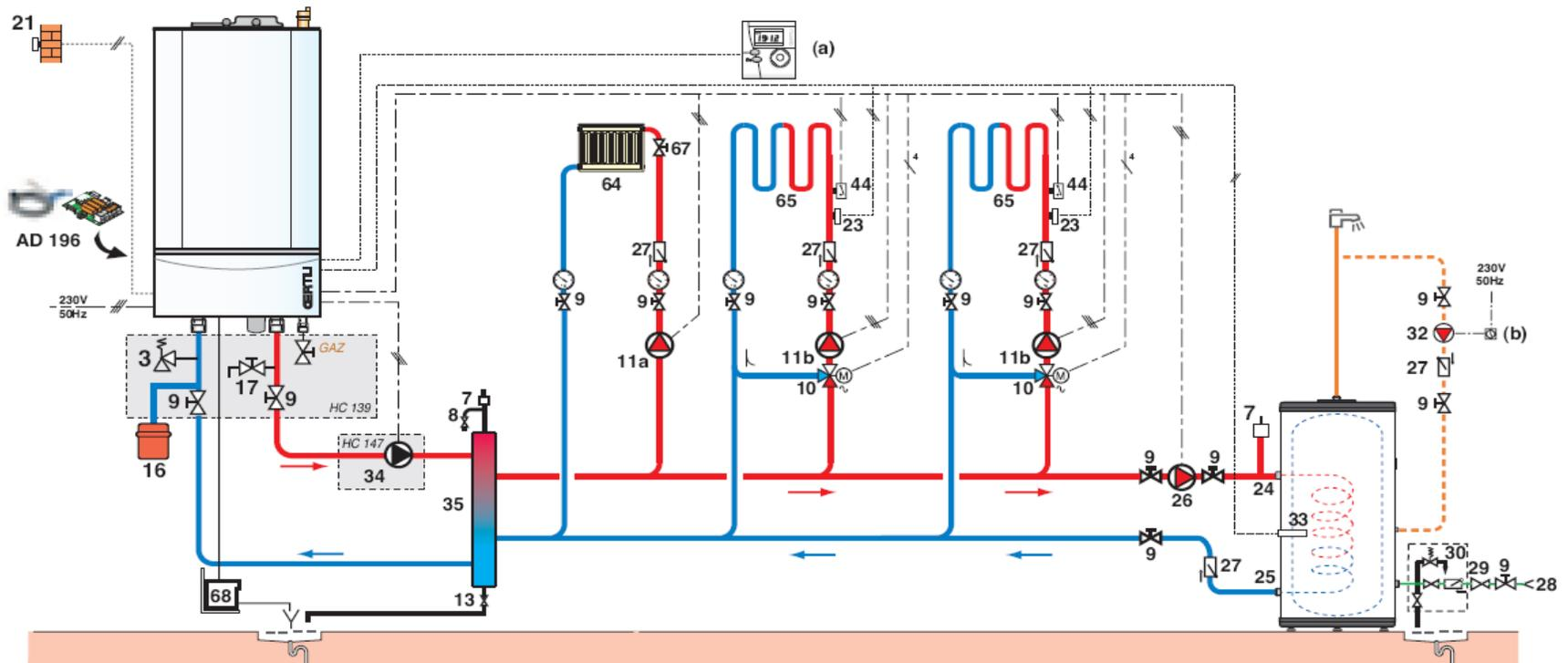
Installation en cascade de 4 chaudières GMR 4045, 4065 ou 4090 Condens avec 4 circuits avec vanne mélangeuse, et 1 préparateur d'ecs de type B
