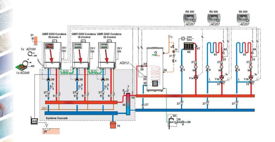
Une OE-tronic 4 pour piloter les circuits et Deux OE-Control.
