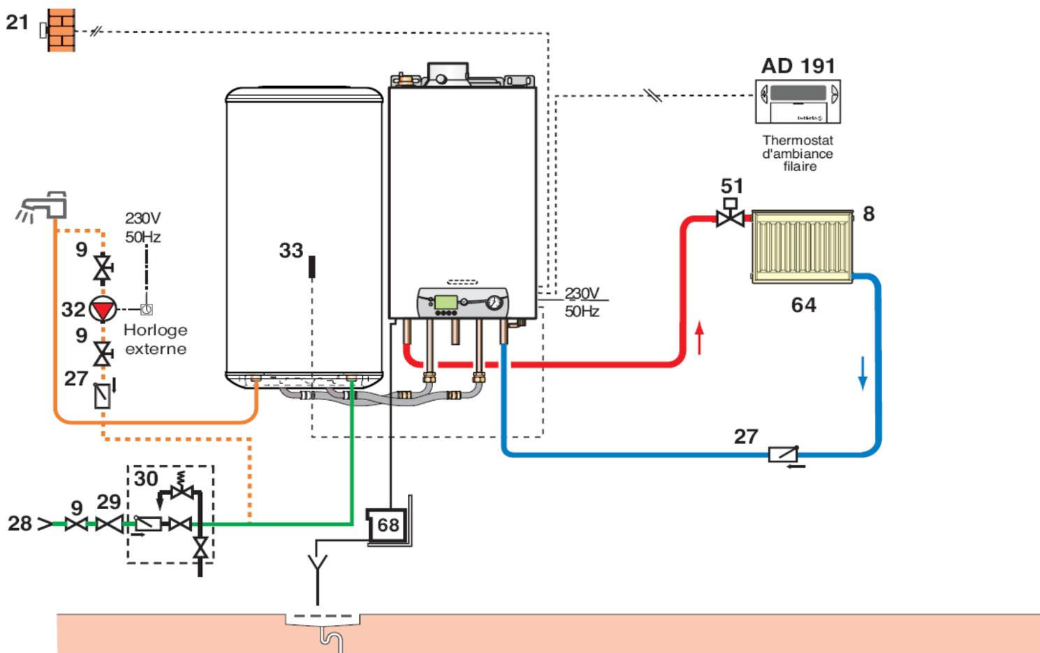
GMR.. Combi Condens avec 1 circuit direct + 1 circuit avec vanne mélangeuse, commandée par 1 commande à distance communicante sans fils et sonde extérieur
