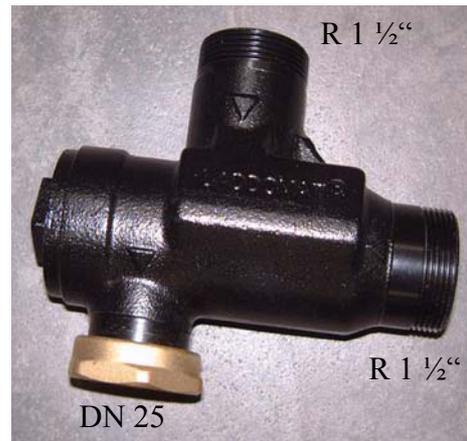
Montage: Wir empfehlen die Montage mit Flachdichtungen und Absperrventilen für eine leichtere Wartung. Die Rückschlagklappe (RK) des Thermomix-Ventils muss in Einbaulage geschlossen sein. Gegebenenfalls den Kunststoffeinsatz in die Entsprechende Position drehen. Bitte beachten Sie die Strömungsrichtung. Bei der Montage des Ventils bitte mit einer Zange gegenhalten.
