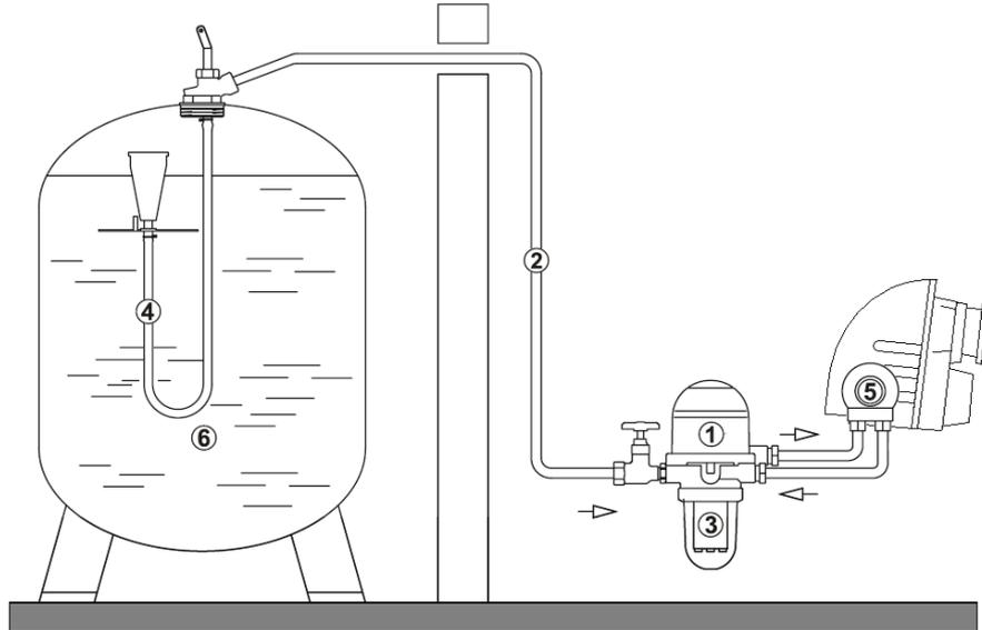
2. L'installation avec le système monotube et séparateur d'air se compose de:
