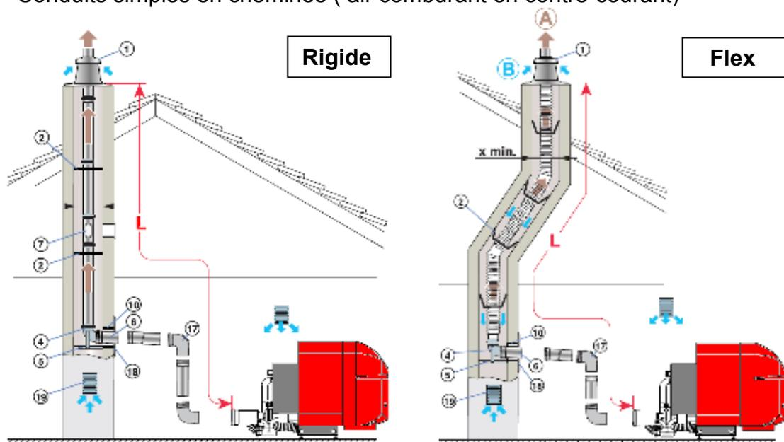
Toujours s'assurer que L soit inférieur à  $L_{max}$ .  $L_{max}$  se mesure en additionnant les longueurs des conduits air/fumées droits et les longueurs équivalentes des autres éléments.
