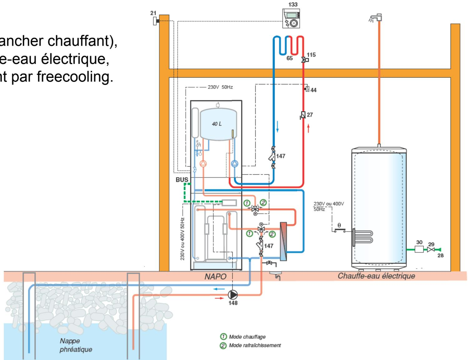
PAC NAPO avec groupe thermodynamique et module hydraulique en relève d' une chaudière PUX 150,
