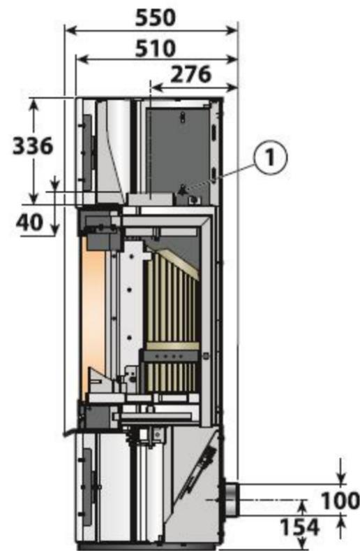
① Raccordement fumées Ø 150 mm
