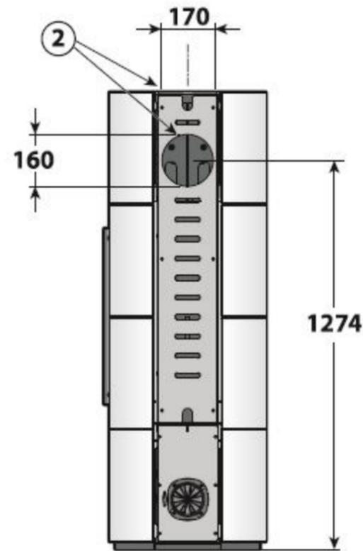
② Orifice pour sortie buse de fumée par le dessus ou par l'arrière
