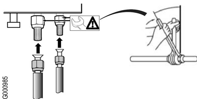
**⚠ Retenir le raccord à l'aide d'une clé plate pour ne pas vriller le tube interne durant le serrage.**
