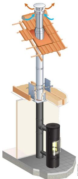
**i** Aucun poêle **non étanche** ne peut être raccordé sur un conduit concentrique.
