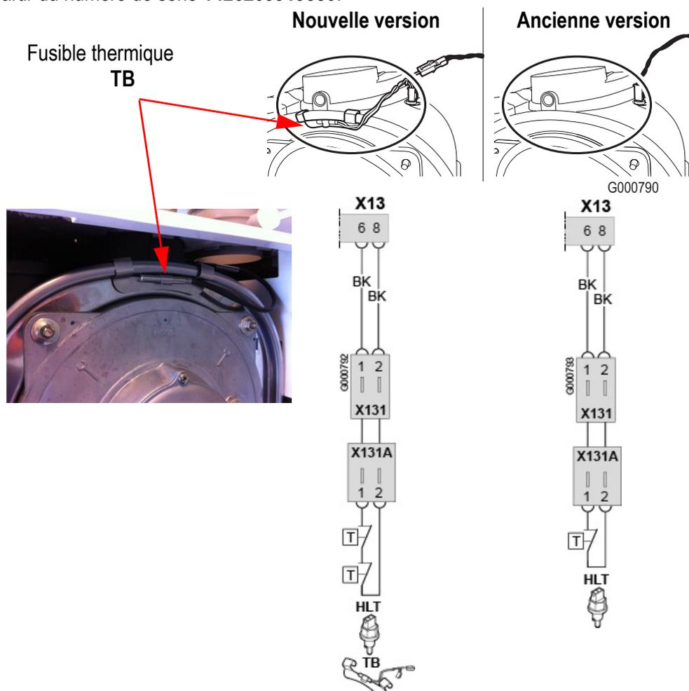
Lors de l'entretien annuel, vérifier l'isolation de plaque avant de porte foyer et remplacer impérativement les joints. En pièces de rechange, l'isolation de plaque foyer est livrée systématiquement avec un fusible thermique, à monter sur la plaque avant de l'échangeur.
