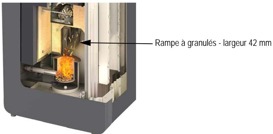
L'ouverture de la rampe à granulés passe de 35 mm à 42 mm pour optimiser le passage des granulés.
