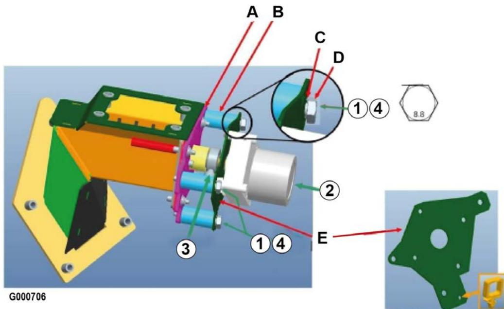
1. Fixer les 4 entretoises B + la plaque E + le support A à l'aide des 4 vis D (sans les serrer) + rondelles à dents C.
