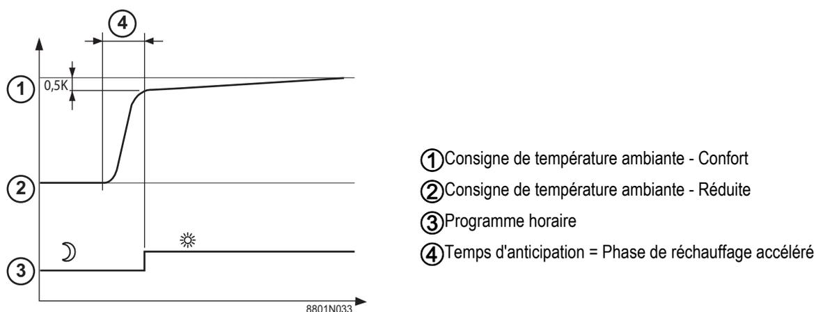
La fonction d'anticipation calcule l'heure de redémarrage du chauffage pour atteindre la température ambiante désirée moins 0.5 K à l'heure programmée du passage au mode confort.
