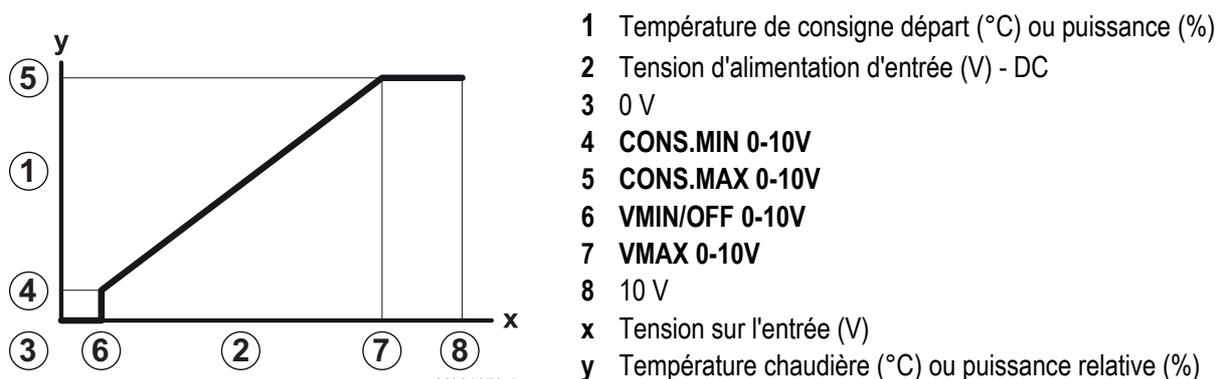
Si la tension d'entrée est inférieure à **VMIN/OFF 0-10V**, la chaudière est à l'arrêt.
