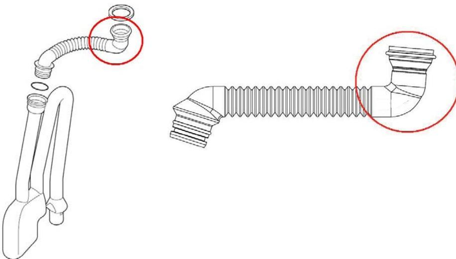
La fuite de condensats au niveau du raccord peut détériorer le ventilateur.
