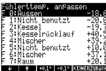
Für die Korrektur von Fühlerabweichungen und Leitungswiderständen können mit dieser Funktion die Fehler kompensiert bzw. korrigiert werden.
