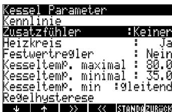
Als Zusatzfühler wird der zweite Fühlereingang des Regelkreises bezeichnet. Beim
