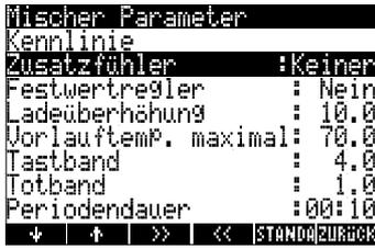
Als Zusatzfühler wird der zweite Fühlereingang des Regelkreises bezeichnet. Beim
