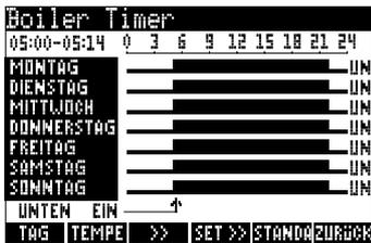
UN...Unten EIN (unterer Fühler für Regelung zuständig)
