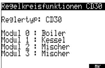
Nach Bestätigung mit der Taste **OK** werden die gewählten Zuordnungen zur Kontrolle noch einmal angezeigt
