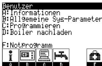
Ist ein Regelkreis des Reglers als Boilerkreis definiert, kann mit Hilfe dieses Menüpunktes der Boiler einmalig nachgeladen werden.
