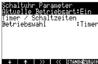
Damit die Betriebsart umgestellt werden kann, muss unter Punkt 5.3.4.1.3 die Betriebswahl auf *Timer* gestellt werden. (= Standard). Als Betriebsart kann *Ein* oder *Aus* eingestellt werden. Der Menüpunkt dient zum Einmaligen manuellen Umschalten des Ausgangs. Der nächste gegenteilige Timer-Schaltbefehl hebt diese Einstellung wieder auf.
