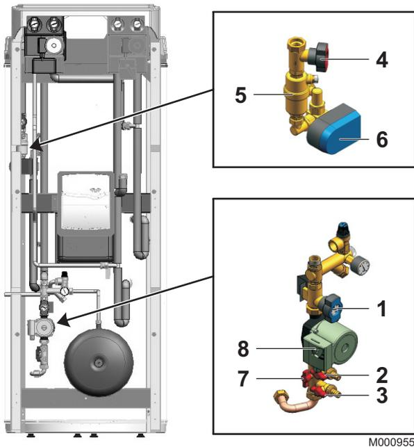
1. Raccorder la conduite de remplissage au robinet de remplissage et de vidange (2) et la conduite de vidange au robinet de remplissage et de vidange (3) puis ouvrir les robinets.
