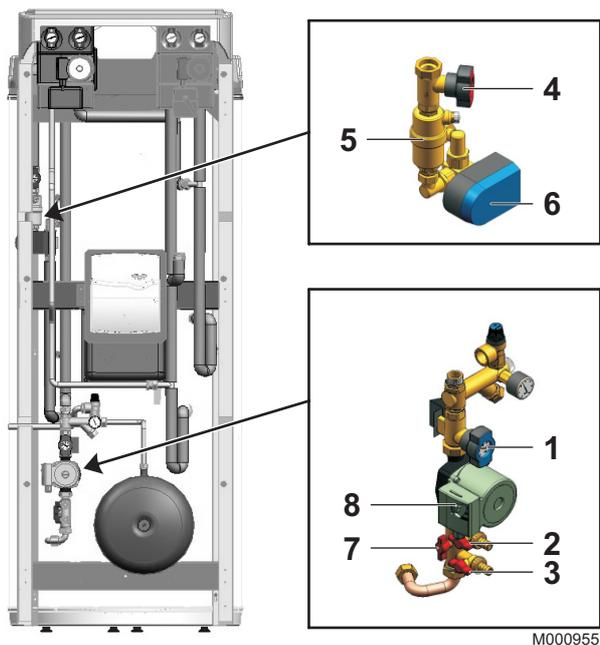
1. Vérifier que les vannes à boisseau sphérique (4) et (1) et le robinet (7) sont en position ouverte.
