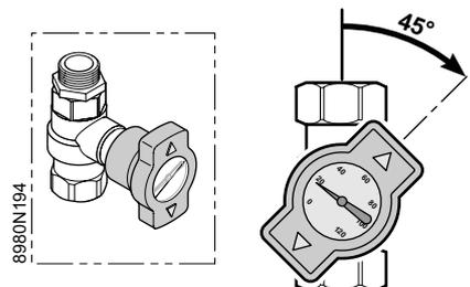
1. Pour le remplissage, le dégazage et le rinçage de l'installation, les vannes à boisseau sphérique (1) et (4) doivent être positionnées à 45° (voir illustration).
