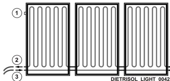
Le départ ② et le retour ③ peuvent être raccordés directement aux tuyauteries montantes grâce au kit de raccordement.
