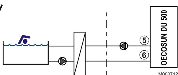
**!** Lorsqu'une piscine est raccordée au préparateur QUADROPAC DUP 500, le débit doit rester inférieur à 1.5 m<sup>3</sup>/h afin d'éviter la destruction des couches de température dans le préparateur.
